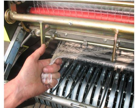
Poussez énergiquement avec les mains sur la vis de réglage de découpe (A) du filet de manière à couper le filet superflu.
