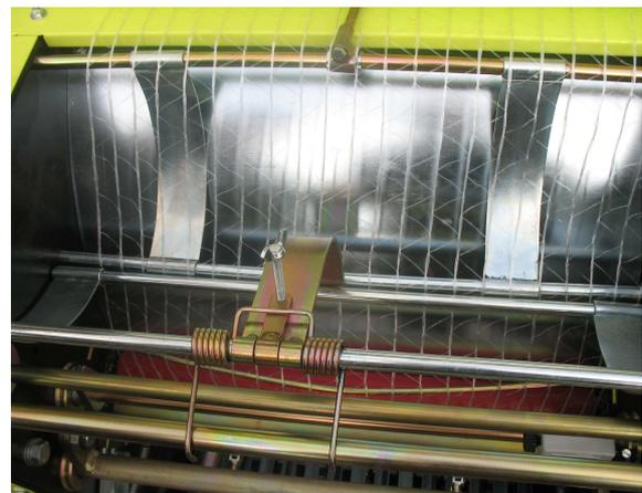
Introduisez le filet en suivant le parcours illustré sur la figure, jusqu'à atteindre les deux rouleaux d'entraînement, posez le filet sur les rouleaux et faites-les tourner avec les mains de façon à ce que le filet descende vers la chambre de pressage.
